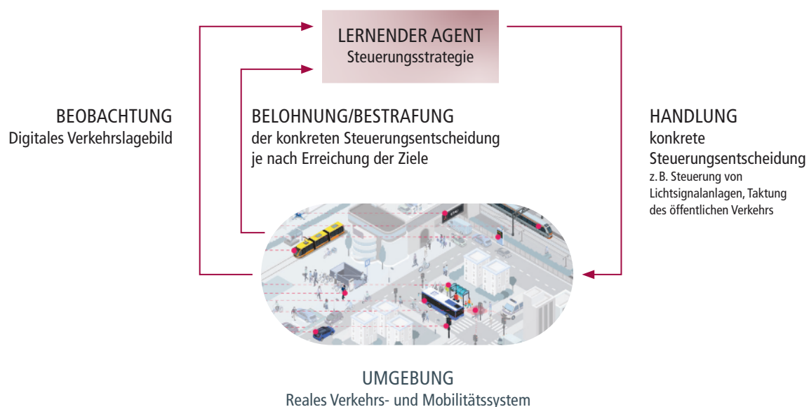
Abbildung 5: Komponenten eines RL-Framework, bezogen auf KI-basierte Verkehrs- und Mobilitätssteuerung
